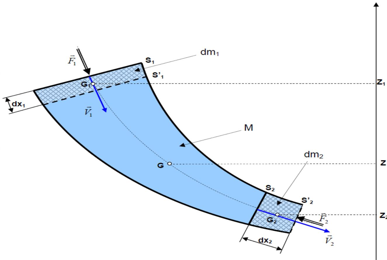
A l'instant  $t$  le fluide de masse  $(dm_1 + M)$  est compris entre  $S_1$  et  $S_2$ . Son énergie mécanique est :
