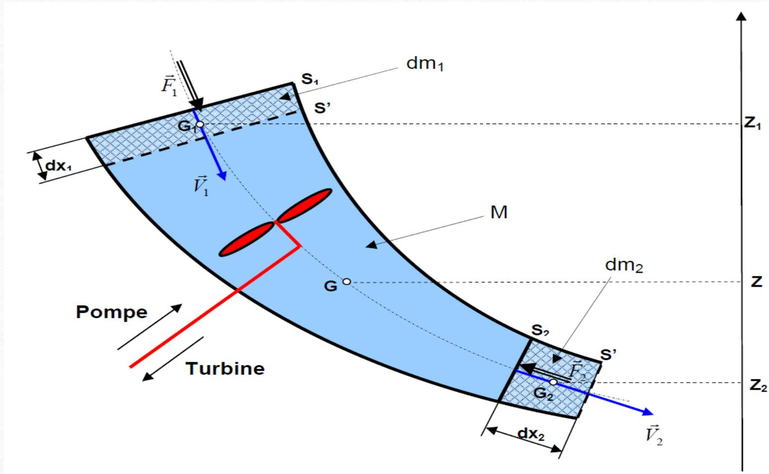
A l'instant  $t'=(t+dt)$  le fluide de masse  $(M+dm_2)$  est compris entre  $S'1$  et  $S'2$ . Son énergie mécanique est :
